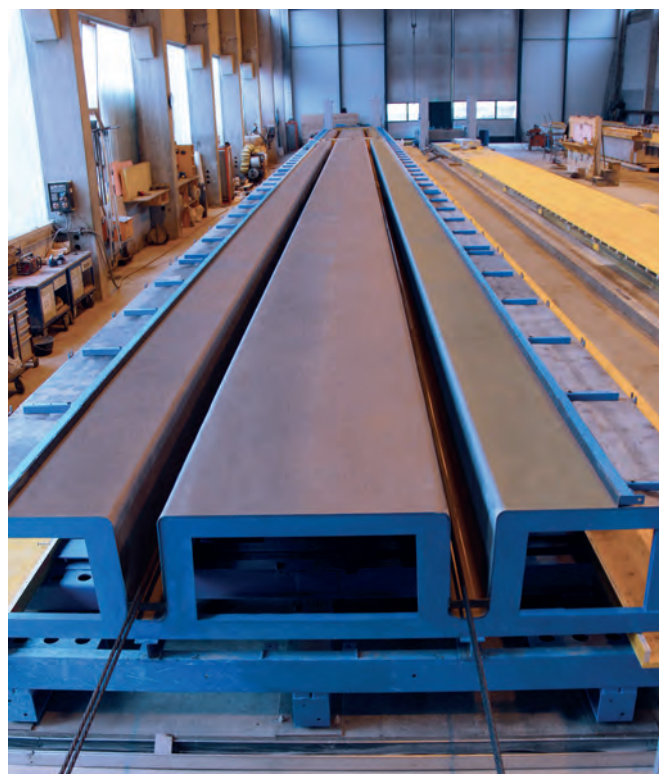
Для завода в Шахене фирма Теспосот разработала универсальную опалубочную систему с двумя различными опалубками: первая опалубка длиной 46 м служит для производства ребристых перекрытий и используется в настоящий момент для выпуска изделий под заказ
