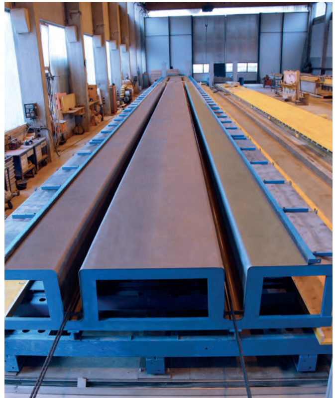
Firma Tecnocom opracowała dla zakładu w Schachen uniwersalny system formowania z dwiema różnymi formami: pierwsza, o długości 46 m, jest obecnie zgodnie ze swoim przeznaczeniem wykorzystywana do produkcji płyt TT.
