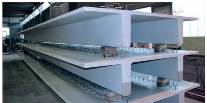
I solai a doppia T, lunghi 10.5 metri e larghi 2.5 metri, vengono utilizzati per la produzione del nuovo centro tecnico SRF vicino a Zurigo. Più di 250 di questi elementi dovranno essere prodotti prima dell'inizio dell'estate 2017.
