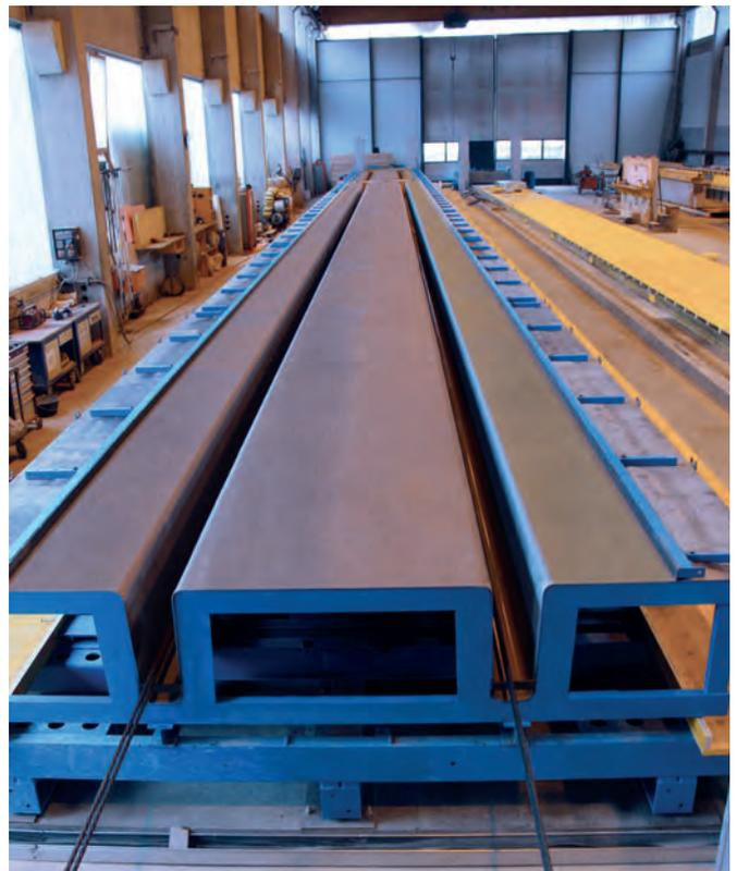
Per l'impianto di Schachen la Tecnocom ha sviluppato un sistema flessibile con due tipi diversi di casseri: con il primo, lungo 46 metri per la produzione di solai a doppia T, vengono attualmente realizzati elementi prefabbricati in calcestruzzo.
