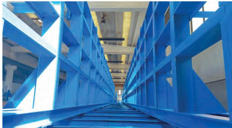
*Il cassero per la produzione di travi e pilastri ha delle sponde verticali con un'altezza fino a 2 m. Sono costituite da quattro moduli per ogni lato che possono essere controllati separatamente tramite dei motori elettrici.*
