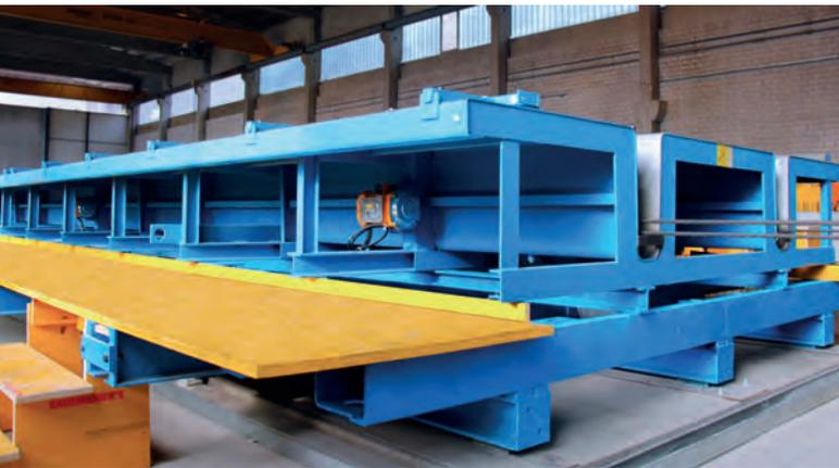
*Nel momento in cui il cassero per i solai a doppia T non sarà più necessario, potrà essere smontato dal telaio di base e sostituito con un secondo cassero per la produzione di elementi tipo pilastri.*
