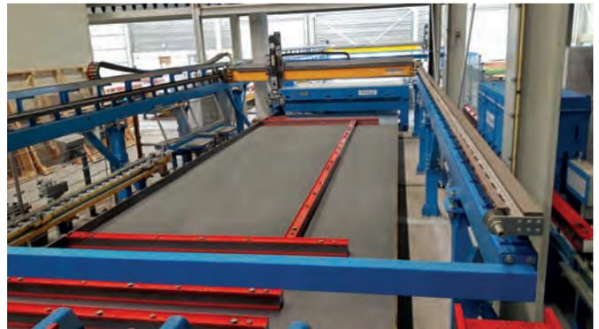
Uno de los aspectos destacados de la instalación a carrusel de bandejas es el robot de encofrado y desencofrado Form Master. Gracias a los pasos de trabajo completamente automáticos, los elementos prefabricados de hormigón son producidos de forma flexible y rápida.
