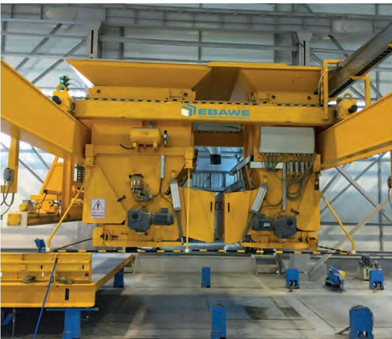
Бетонораздатчики для эффективной подачи свежего бетона укомплектованы двумя бункерами. Второй бункер меньшего объема предназначен для цветного или легкого бетона, который может наноситься на сборные железобетонные элементы в качестве фасадного слоя
