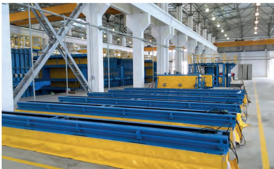
С помощью 15 дополнительных форм обеспечивается производство ригелей (на переднем плане), лестничных маршей (в центре) и вентиляционных шахт (на заднем плане). Интегрированная система обогрева ускоряет процесс выдержки бетона
