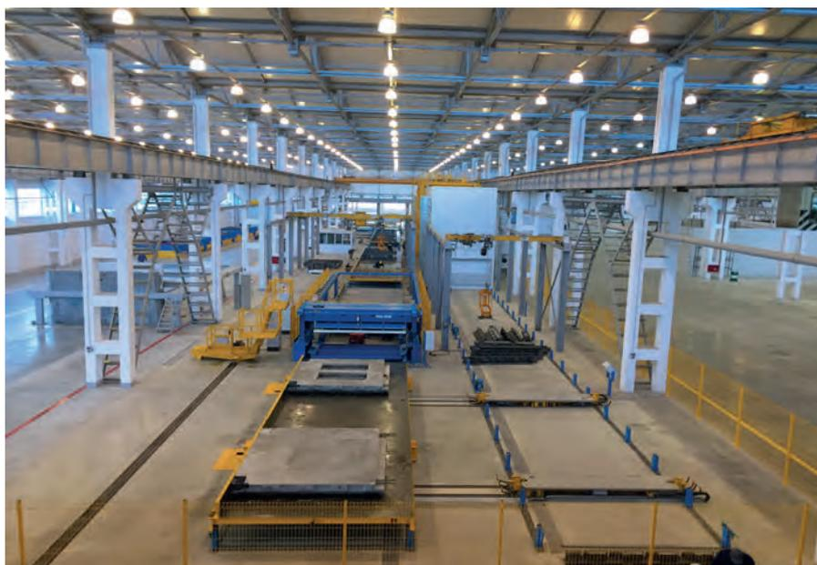
На двух линиях циркуляции паллет (на рис. показана линия ашхабадского завода) производятся стеновые массивные и сэндвич-панели
