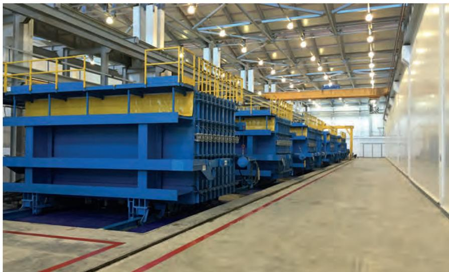
18 кассетных форм позволяют производить массивные стены и перекрытия на очень небольшой площади
