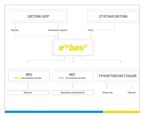
В условиях современного завода ЖБИ комплексные и интегрированные решения по программному обеспечению вносят существенный вклад в обеспечение бесперебойных производственных и коммерческих процессов. Системы ERP и MES группы Progress Group были разработаны ее дочерним предприятием Progress Software Development (PSD) специально для промышленности сборного железобетона
