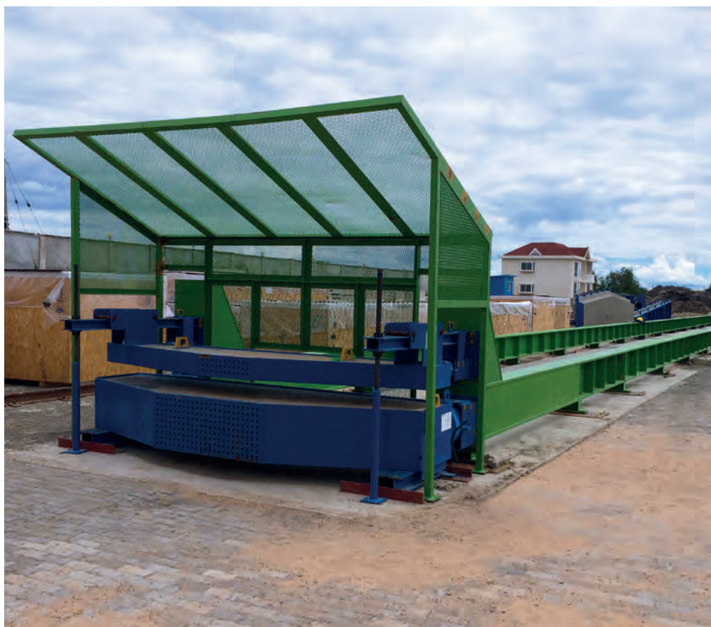
Опалубочную систему с собственной системой преднапряжения и обжатия можно оснащать различными комплектами бортовой опалубки и вкладышей. Эта компактная опалубка позволяет изготавливать балки различного типоразмера
