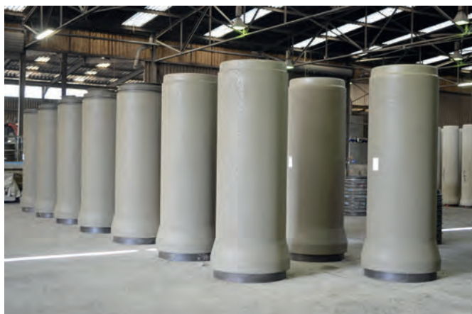
Свежеотформованные трубы DN 700, изготовленные на радиальном прессе RP 1630
