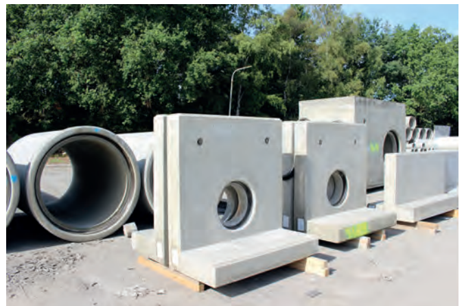
Элементы подпорных стенок
