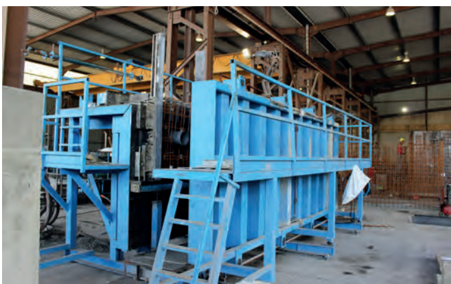
Опалубка для производства подпорных стенок
