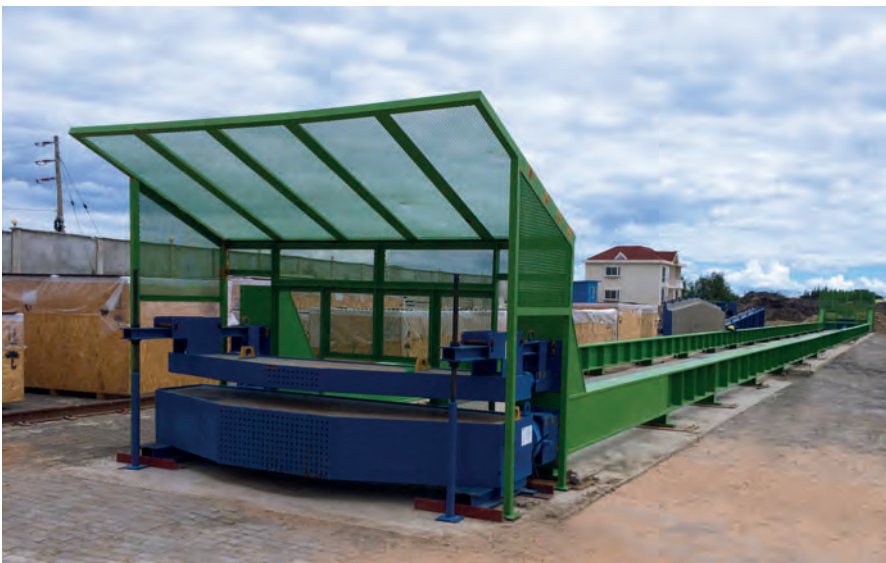
Un cassero con un sistema per l'auto-assorbimento delle forze di precarico può essere attrezzato con diversi casseri laterali ed inserti. Ciò consente la produzione flessibile di diversi tipi di travi.
