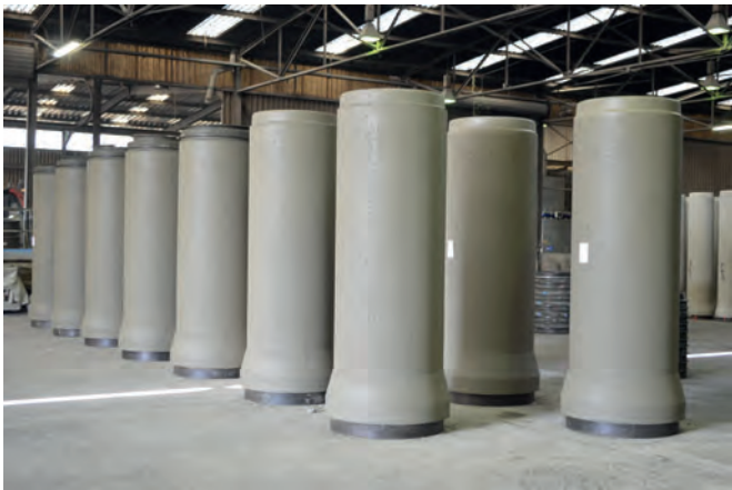
Tubi DN 700 appena realizzati, prodotti con la RP 1630
