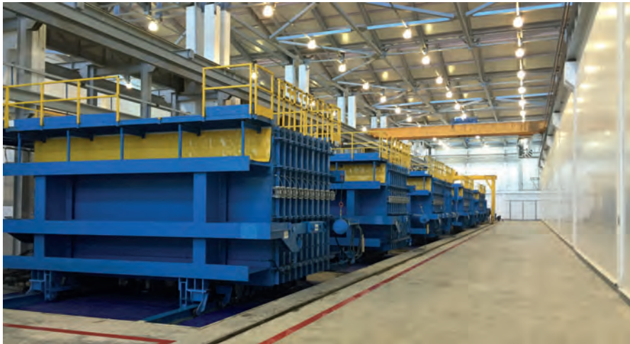
Con un totale di 18 casseforme in serie si producono pareti massicce e solai pieni su una superficie minima.
