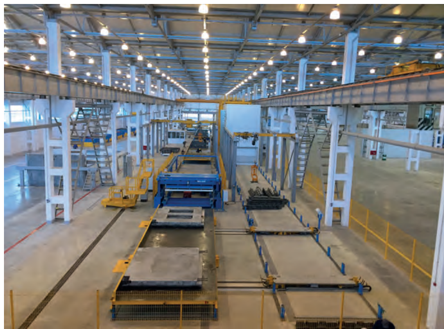
In due impianti a carosello di pallet (nella foto quello sito ad Ashgabat) si producono pareti massicce e sandwich.
