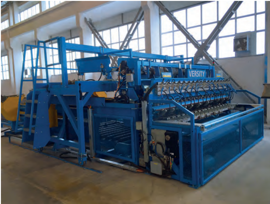
In ciascuno dei tre stabilimenti modernizzati si è installato un impianto di saldatura reti del tipo Versity per la produzione di reti standard. Staffe e barre sono prodotte con 9 macchine aggiuntive.
