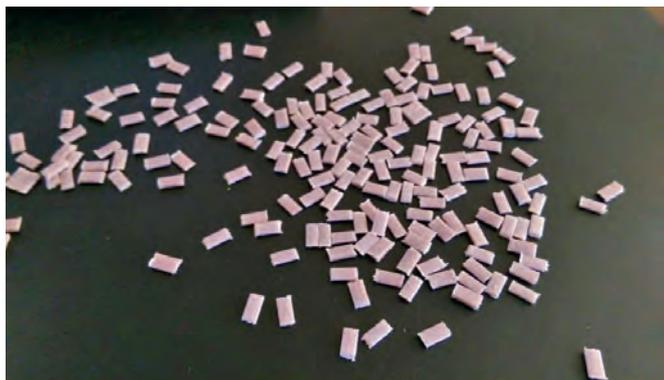
Les granulés sont disponibles sous une forme rectangulaire et se composent de LDPE (polyéthylène) provenant de matériau d'emballage recyclé
