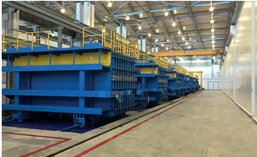
Avec au total 18 batteries de coffrage, il est possible de produire des murs et des planchers massifs sur de très petites surfaces.
