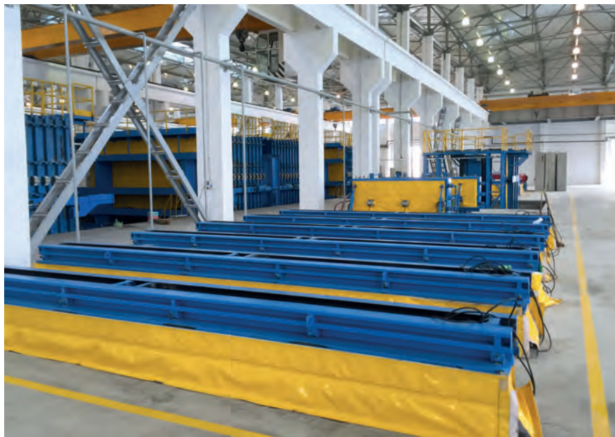
Les 15 moules supplémentaires permettent de fabriquer, entre autres, des poutres (au premier plan), des escaliers (au milieu de la photo) ou encore des cheminées d'aération (en arrière-plan). Un système de chauffage intégré permet d'accélérer le durcissement du béton.
