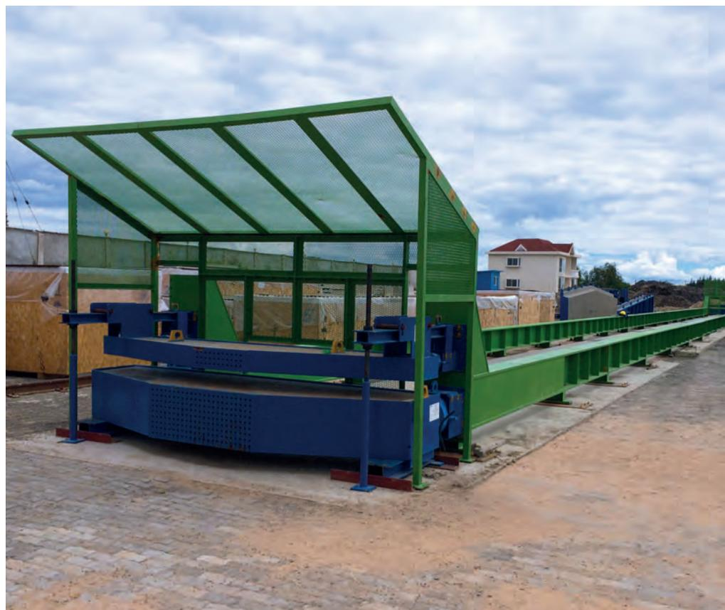
Un coffrage doté d'un système d'absorption automatique des forces de précontrainte peut être équipé de différents coffrages latéraux et inserts. Ceci permet la production flexible de différents types de poutres.
