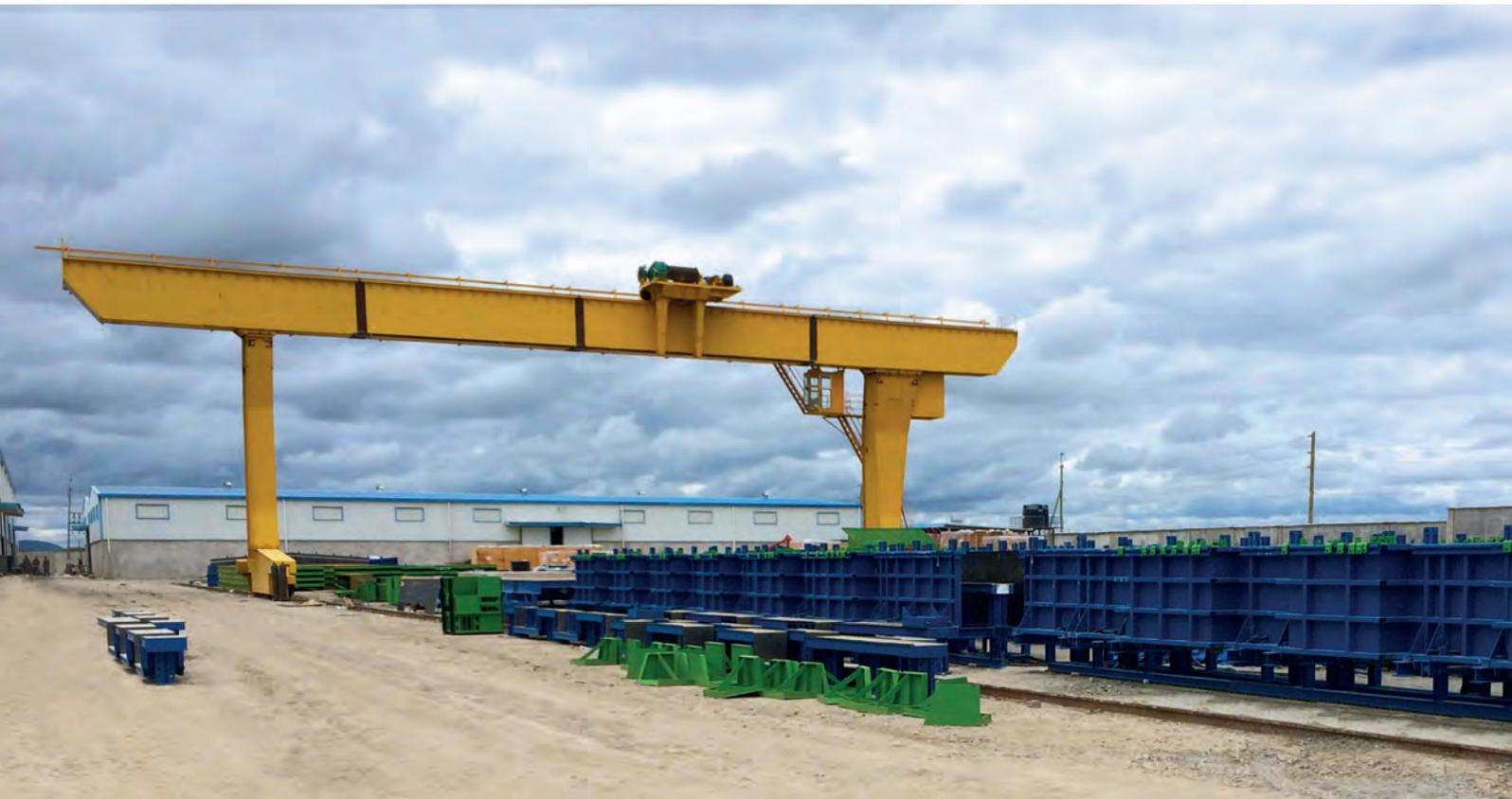
Les six coffrages de chacun 18 m de long servent à la fabrication de colonnes pour la construction commerciale.
