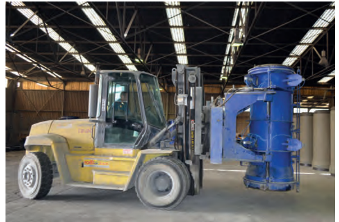
Carretilla con un revestimiento de molde de 3 piezas
