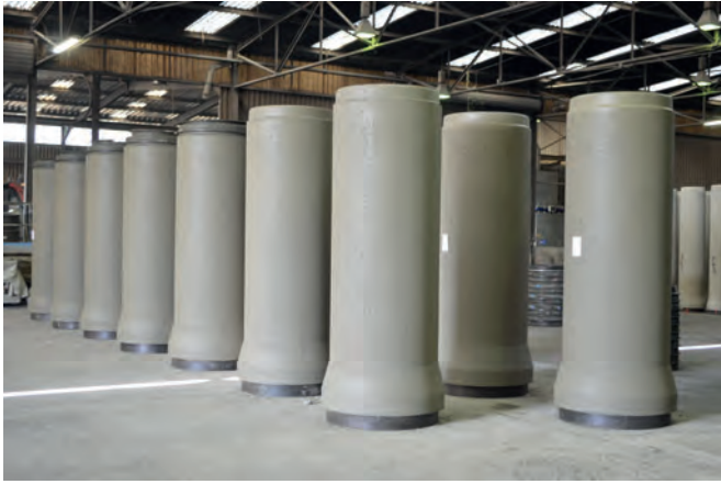
Tubos DN 700, recién fabricados, producidos por la RP 1630
