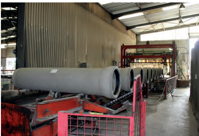
Línea de comprobación de los tubos fabricados
