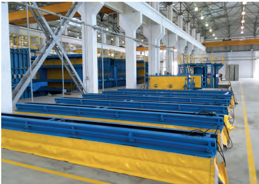
Con encofrados adicionales, en total 15, se pueden fabricar, entre otras cosas, vigas (primer plano), escaleras (centro de la imagen) y pozos de ventilación (fondo). Un sistema de calefacción integrado acelera el curado del hormigón.
