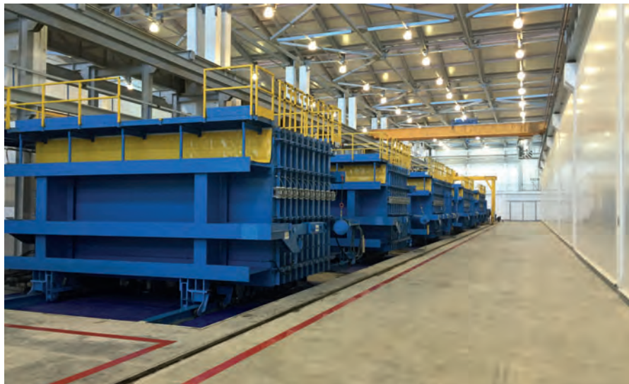
Mit insgesamt 18 Batterieschalungen werden auf kleinster Fläche Massivwände und -decken hergestellt.
