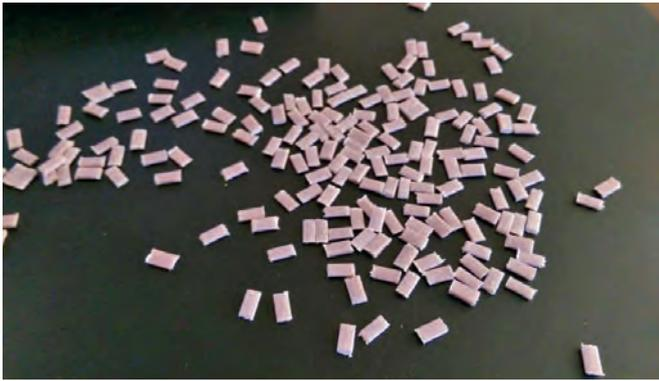
Das Granulat ist in Rechteckform erhältlich und besteht aus LDPE (Polyethylen), welches aus Verpackungsmaterial recycelt wird.
