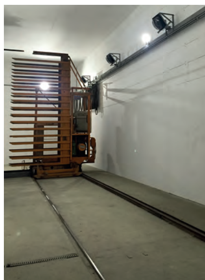
Воздушная циркуляция в проходе для подвижной платформы обеспечивает сухой климат в этой зоне и рабочей зоне транспортной группы, препятствуя образованию конденсата или капельного тумана, который может привести к выходу из строя лазерного датчика линейного пути
