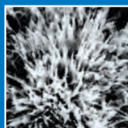
Хурех Crystallization (бетон после выдерживания)
