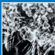
Хурех Crystallization (бетон сразу после обработки)
