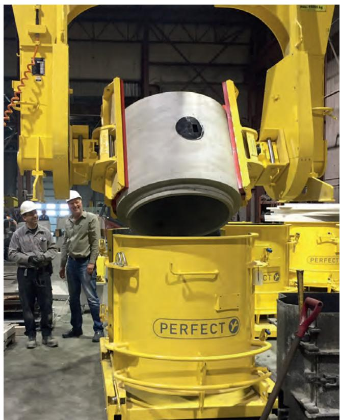
Готовые кольца с днищем извлекаются из формы и поворачиваются на 180° при помощи захвата
