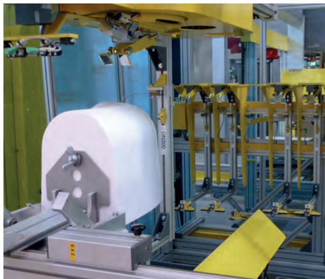
Отличительной особенностью технологии Perfect является горячепроволочная система с компьютерным управлением для высокоточного раскряя негативов водовода и формообразующих вкладышей соединительных патрубков
