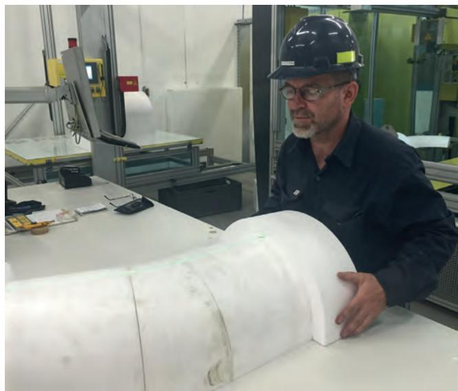
Позиционирующие лазеры помогают рабочему состыковать компоненты негатива водовода и одновременно провести контроль качества
