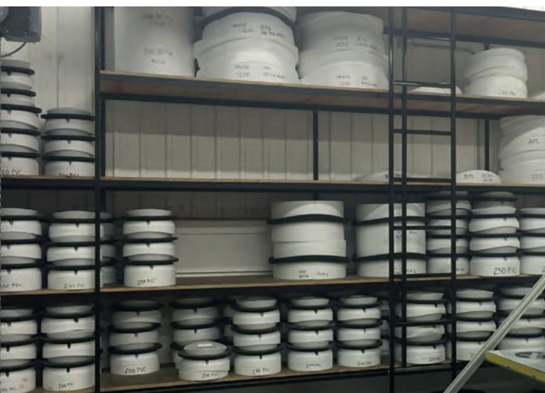
Пенополистироловые вкладыши соединительных патрубков с интегрированными уплотнителями, раскроенные по индивидуальным чертежам с помощью профильного горячепроволочного резака
