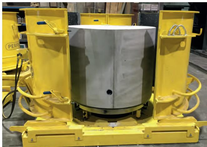
Как правило, распалубка монолитных колец с днищем, изготовленных из высокоподвижной смеси, на заводе Fortier 2000 Ltee осуществляется уже на следующие сутки
