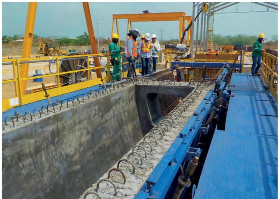
*Un sistema di vibrazione e di riscaldamento garantisce una compattazione e stagionatura uniformi del calcestruzzo messo in opera. Per il "viaducto Gran Manglar", il ponte viadotto stradale più lungo della Colombia, vengono prodotte travi a V di tre diverse lunghezze e dal peso che arriva fino a 85 tonnellate.*
