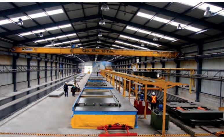
*Nel dicembre 2014 entravano in funzione gli impianti in un capannone già esistente. Da allora, EPCE vi produce solai alveolari precompressi e pareti in getto pieno.*
