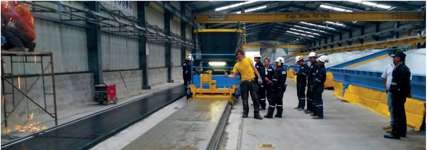
I solai alveolari precompressi vengono prodotti su due piste di 114 metri di lunghezza, grazie a una vibrofinitrice di Echo Precast Engineering.
