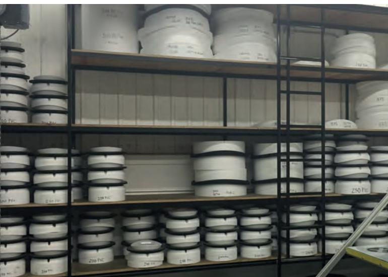
Mittels Profilsäge aus Polystyrol-Hartschaum maßgenau zugeschnittene Rohranschlussformteile mit aufgesetzten Dichtungsringen.
