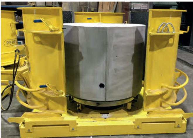
Die aus selbstverdichtendem Fließbeton hergestellten Schachtböden werden bei Fortier 2000 Ltée üblicherweise nach einem Tag entschalt.
