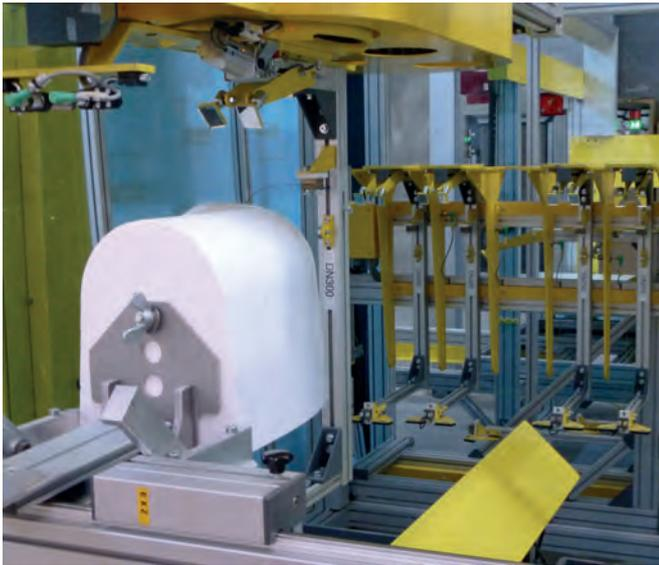
Ein Charakteristikum des Perfect-Verfahrens ist die computer-gesteuerte Heißdrahtsägetechnik für den exakten Zuschnitt der Negativgerinnekomponenten und Rohranschlusskörper.
