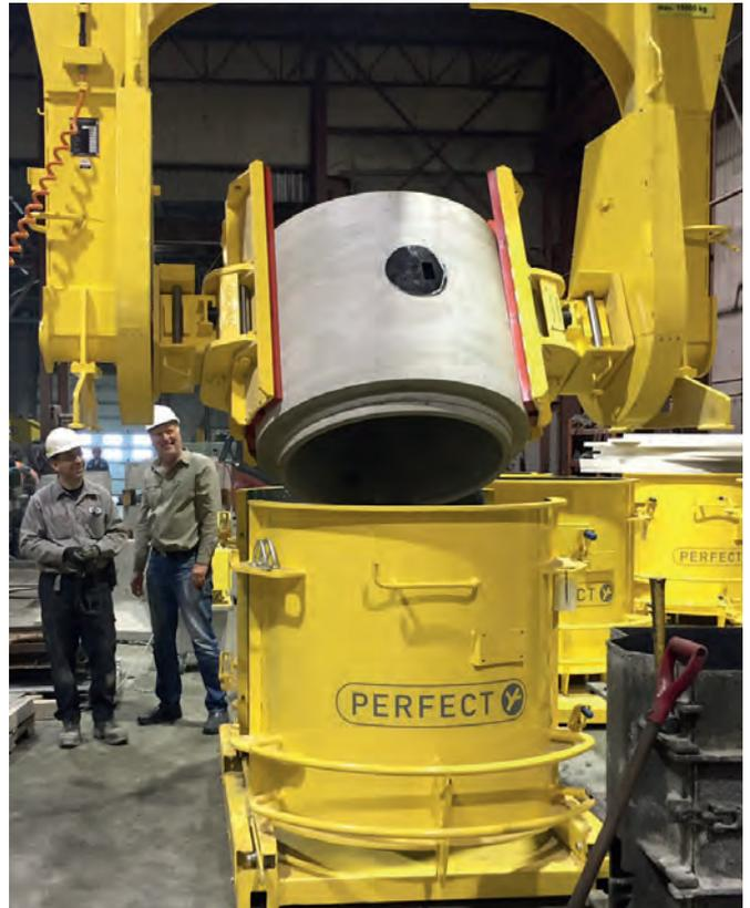
Die fertigen Betonschachtunterteile werden mit Hilfe eines Produktgreifers angehoben und um 180° gedreht.
