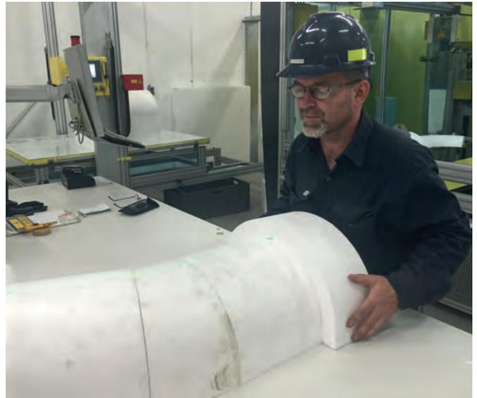
Positionslasern unterstützen den Arbeiter beim Zusammensetzen der Negativgerinne und sorgen so für eine gleichzeitige Qualitätskontrolle.
