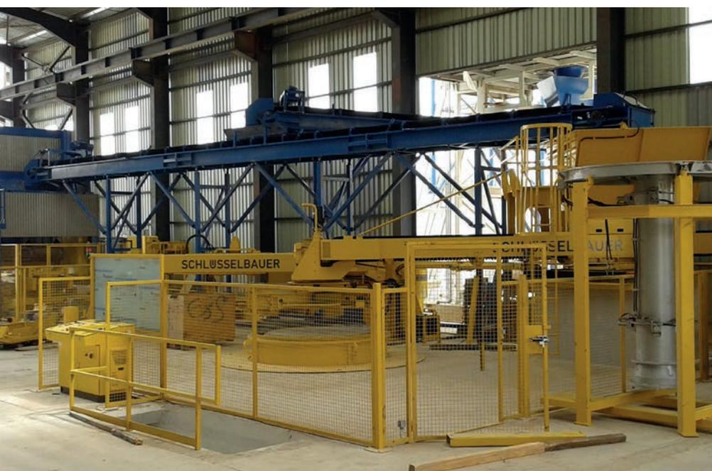
Автоматическая установка Exact XL для производства труб на бетонном заводе алжирской компании Trans-Canal Centre
