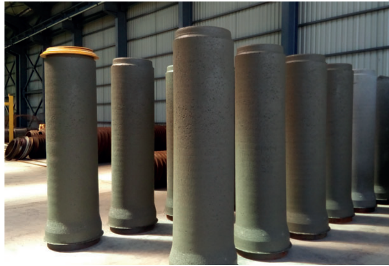
I tubi in calcestruzzo appena disarmati rimangono in Trans-Canal Centre per un'altra giornata lavorativa nella zona di indurimento.
