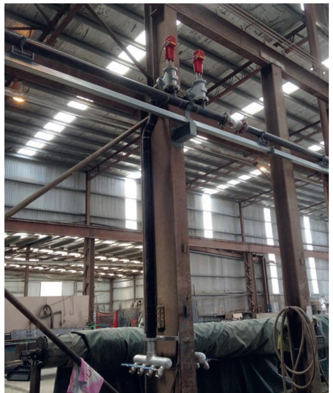
Fig. 4 : Les soupapes à vapeur commandées automatiquement permettent de réguler la quantité de vapeur dans les différentes zones de durcissement ainsi que la température souhaitée pour le béton durant les divers cycles de durcissement.
