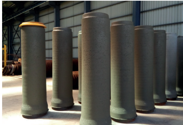
Les tuyaux fraîchement démoulés restent généralement dans la zone de durcissement de Trans-Canal Centre pendant une journée de travail.
