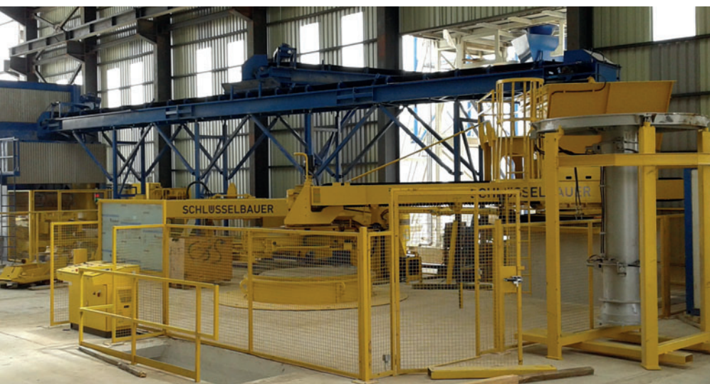
Système automatique Exact XL de production de tuyaux dans l'usine de produits en béton de Trans-Canal Centre à Alger.
