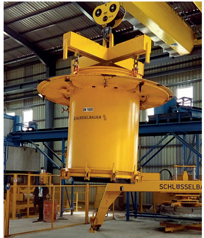
Alimentación de un molde de acero preparado hacia la instalación de producción Exact XL.
