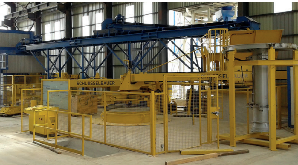
Sistema automático de fabricación de tubos Exact XL en la fábrica de hormigón de Trans-Canal Centre en Argel.
