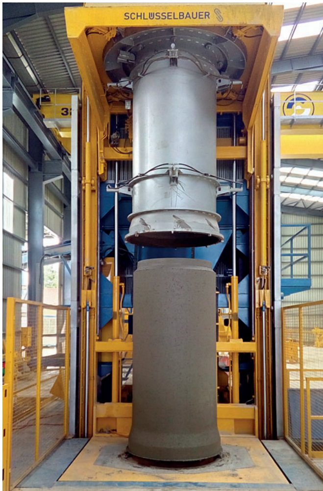
Fertigung eines DN800 Glockenmuffen-Betonrohres auf der von Schlüsselbauer Technology gelieferten Anlage Precise
