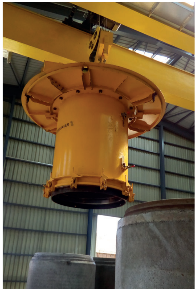
Mit Hilfe eines Hallenkrans werden die frisch betonierten Rohre in den Aushärtbereich gebracht.
