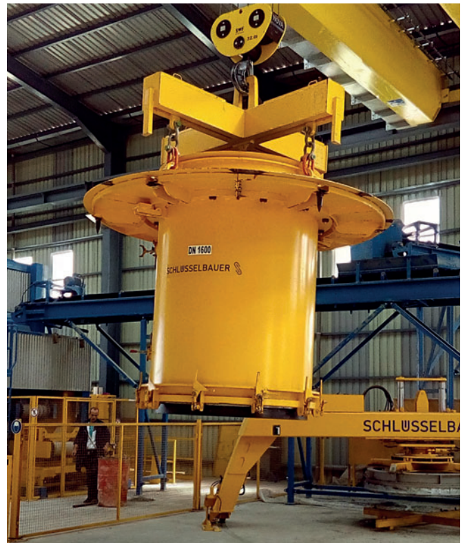
Zuführung einer gerüsteten Stahlform an die Exact XL Produktionsanlage
