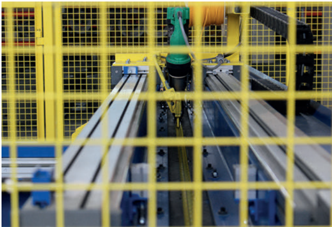
Сварочный робот собственной разработки фирмы Schlüsselbauer прочно и надежно сваривает футеровочный вкладыш в цилиндр
