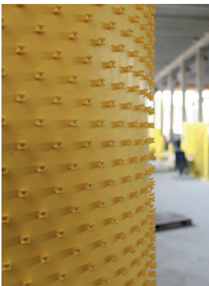
Прочное соединение футеровки с бетонной трубой обеспечивается за счет многочисленных маленьких анкеров на обратной стороне
