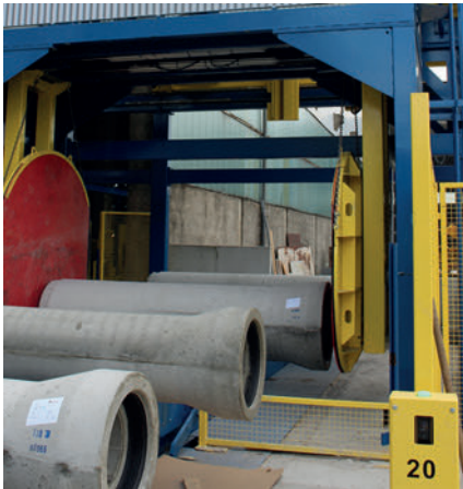
Проверка труб на герметичность
