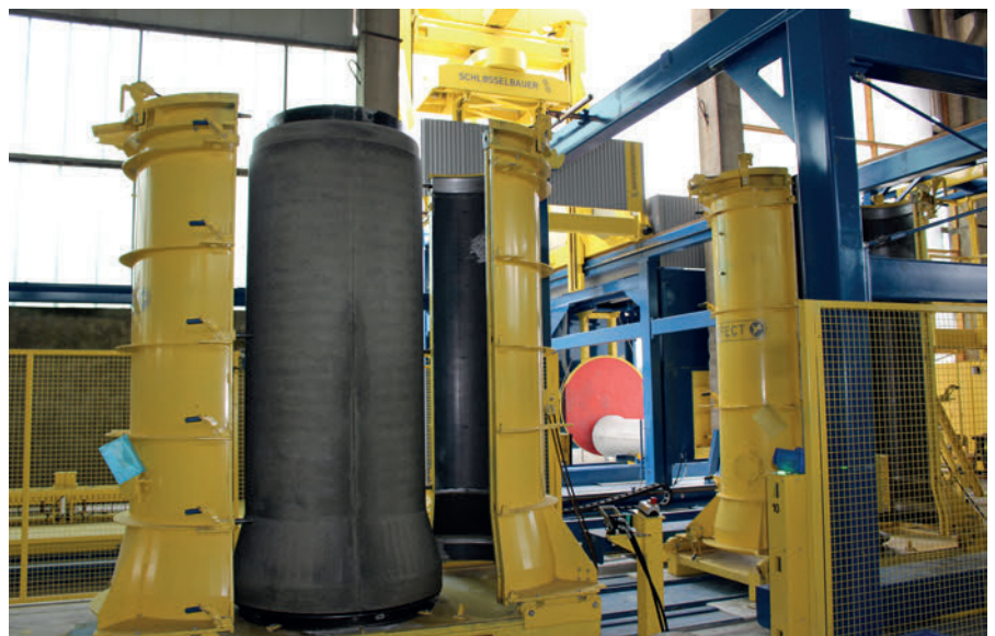
Робот с универсальным захватом для труб всех диаметров осторожно поднимает изделие за сердечник
