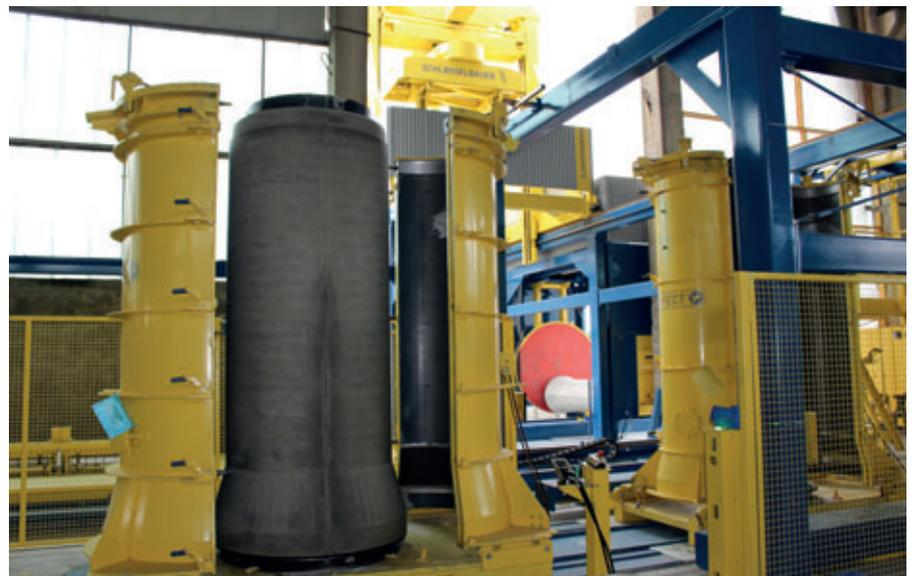
Un robot dotato di pinza universale adatta a tutti i diametri afferra il tubo e lo estrae delicatamente dallo stampo.
