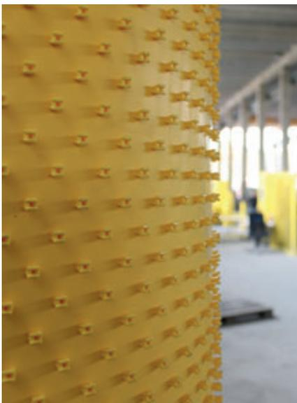
Il collegamento del liner con il tubo in calcestruzzo viene realizzato con numerosi piccoli ancoraggi sul lato posteriore del liner.
