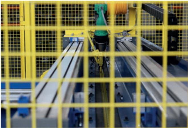
Un robot applica un cordone di saldatura in PE per congiungere le due estremità del foglio. Dopo la saldatura, il foglio è diventato un liner cilindrico.
