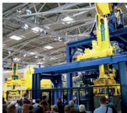
Movimentazione efficiente degli strati dei blocchi tramite il Cuboter Masa
