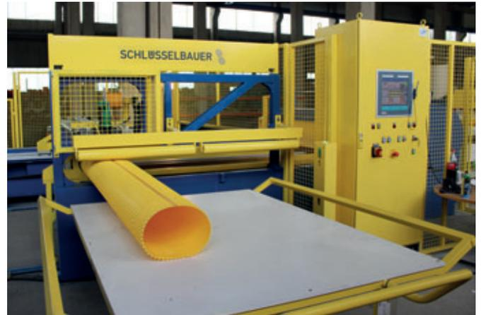
Un cordon de soudure en PE est réalisé à l'aide d'un robot de soudage et les deux bords du film PEHD sont solidement liés. À l'issue de cette procédure le film PEHD forme un cylindre.
