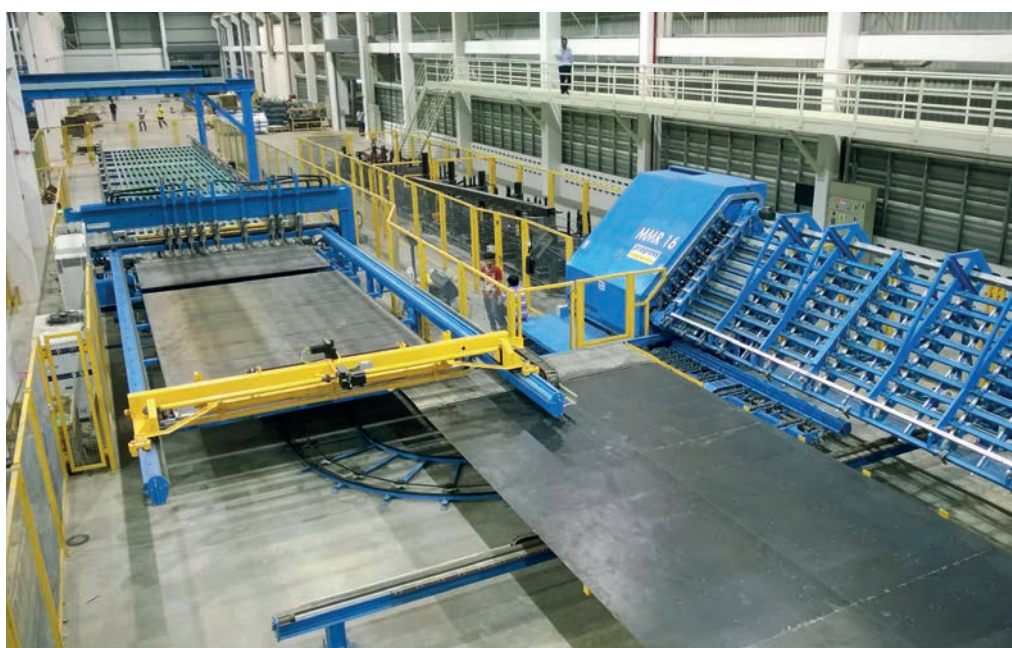
Сеткосварочная установка M-System Evolution изготавливает арматурные сетки по принципу «точно в срок» в точном соответствии с размерами каждой паллеты
