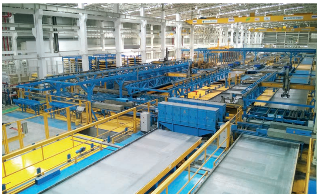
Новый высокопроизводительный завод фирмы Prukca: процессы распалубки, очистки и смазки паллет и установки опалубочных элементов полностью автоматизированы
