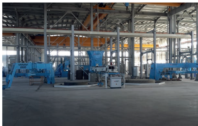
Установка Prinzing-Pfeiffer Variant 3600/2500 для производства железобетонных труб диаметром до 3600 мм и длиной до 3,0 м
