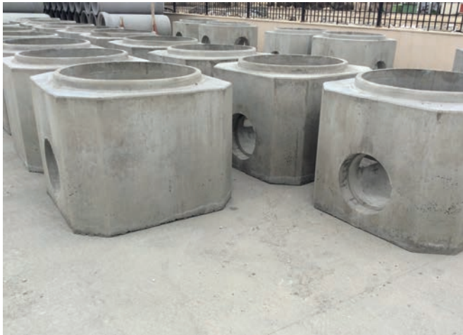
Готовые монолитные кольца с дном с приточными водоводами
