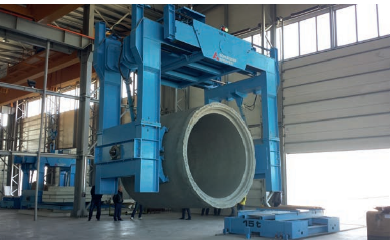
Поворотный захват для труб весом до 15 тонн
