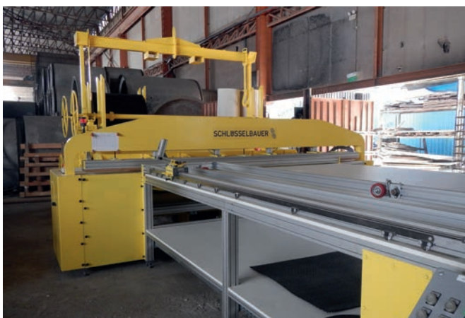
Резка на участки требуемой длины и автоматическая сварка футеровочного вкладыша в соответствии с требуемым номинальным внутренним диаметром
