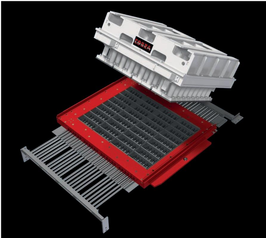
Гидравлическая форма для производства бетонных изделий
