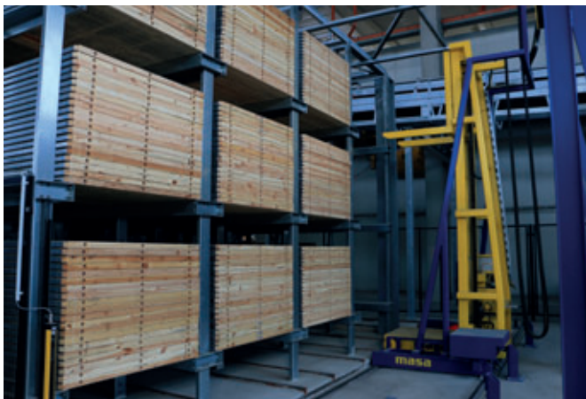
Il trasportatore pacchetti preleva i pacchetti pronti e li riporta automaticamente alla blocchiera o deposita la pila sullo scaffale tampono.
