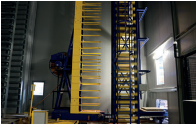
La piattaforma mobile rileva i manufatti appena prodotti sul "lato fresco"
