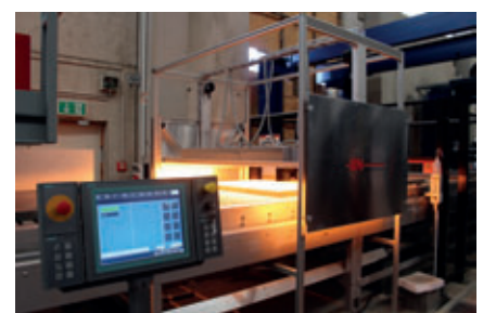
Indurimento della vernice protettiva sotto la luce UV
