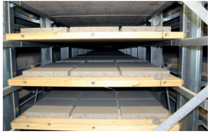
La scaffalatura di stagionatura in versione camera climatizzata a grande capienza
