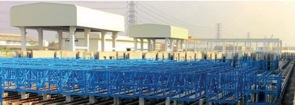
Il magazzino esterno di Pruksa è impressionante: ha lo spazio necessario per accogliere 450 telai di trasporto in cui vengono depositate le pareti massicce pronte. L'intera gestione del magazzino è completamente automatizzata, un'altra punta di diamante dello stabilimento ad alte prestazioni Pruksa.
