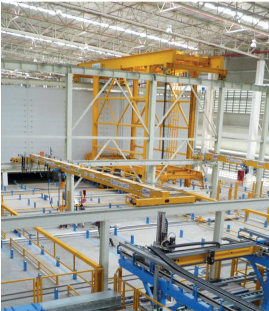
*Il deposito e il prelievo dei pianali viene eseguito da uno scaffalatore completamente automatico. Il sistema ebos calcola la permanenza necessaria nella scaffalatura di maturazione e invia questi dati alla macchina.*
