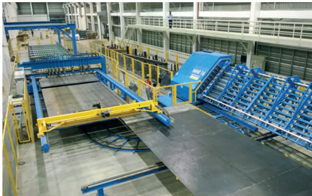
*L'impianto di saldatura reti M-System Evolution realizza reti di saldatura just-in time e precise per quanto riguarda il rispettivo pianali.*
