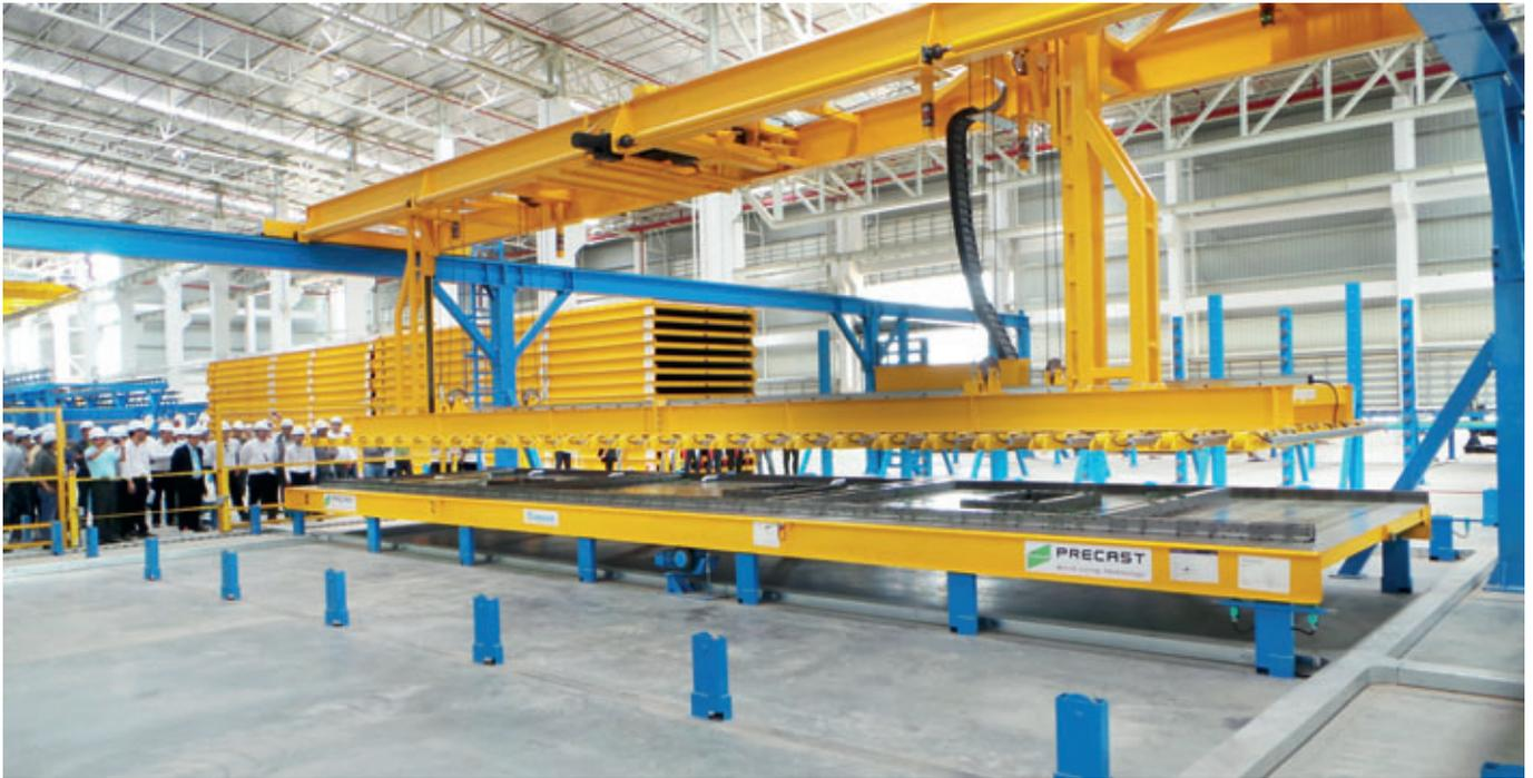
*Nel nuovo stabilimento si è puntato sull'automazione: La preparazione automatica delle reti e l'inserimento delle reti nei pianali cassetteri sono operazioni eseguite dalla traversa di movimentazione.*
