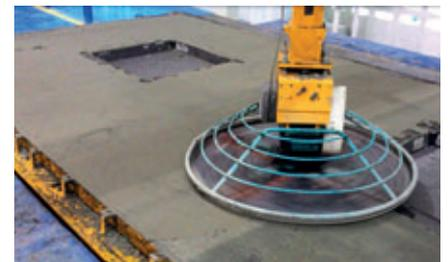
*Per lisciare finemente le superfici degli elementi, il nuovo stabilimento di Bangkok è dotato di sei lisciatrici e di 24 postazioni di lisciatura. Grazie ai comandi completamente automatici, i tempi di ciclo per la lisciatura sono ridotti al minimo e si realizzano elevati risparmi sui costi per il personale.*
