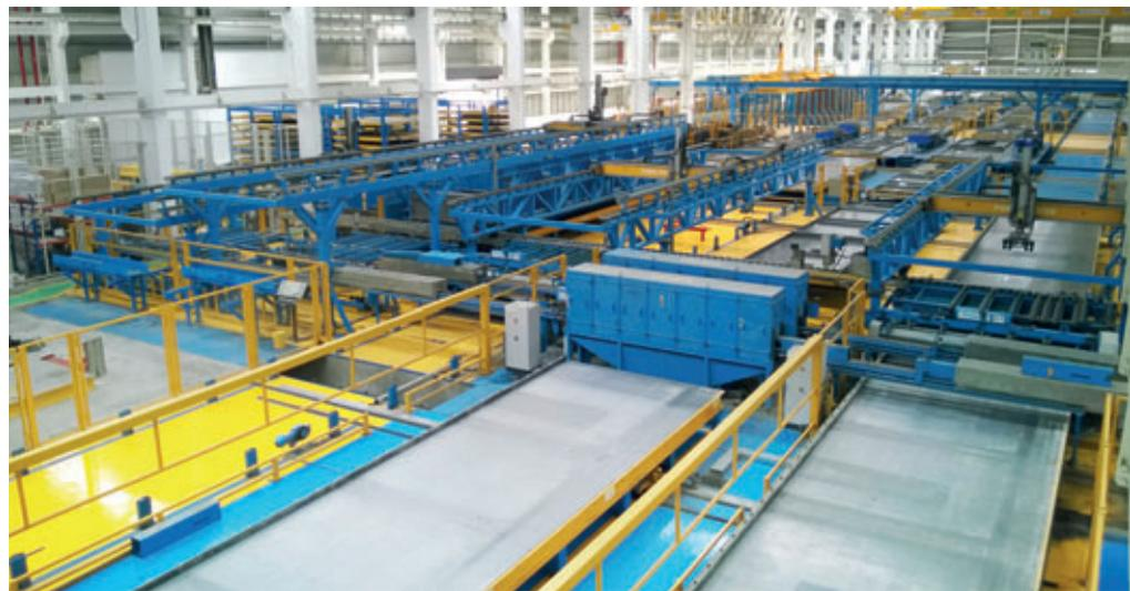
*Uno sguardo allo stabilimento ad alte prestazioni di Pruksa: cassetta e scasseratura dei pianali, pulizia e oliatura dei pianali e delle sponde necessarie sono operazioni interamente automatizzate.*
