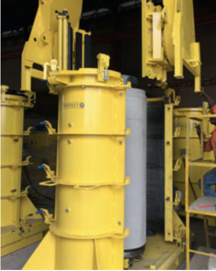
Disarmo di un tubo di sollevamento indurito
