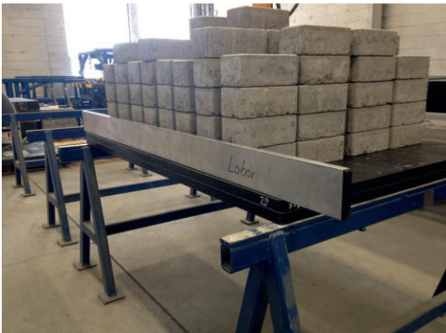
Con la nuova struttura del Wasa Tecboard è stato possibile triplicare, rispetto al vecchio Tecboard, il vecchio modulo di elasticità. Attualmente è di circa 12.000 N/mm<sup>2</sup>
