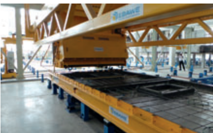
Le distributeur de béton Prukša permet de couler le béton sur toute la largeur de la palette. Ceci entraîne un énorme gain de temps dans le processus de production.
