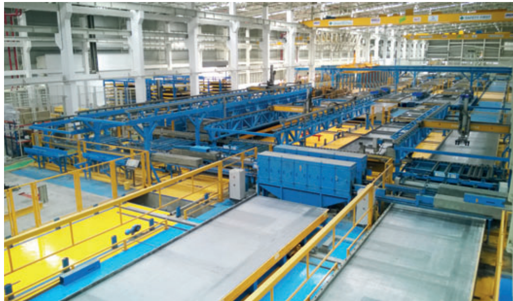
Vue de la nouvelle usine haute performance de Prukha : le (dé)coffrage des palettes ainsi que le nettoyage et l'huilage des palettes et des profilés de coffrage sont complètement automatisés.
