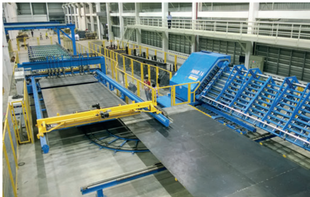
L'installation de soudage de treillis M-System Evolution fabrique les treillis soudés juste-à-temps et sur mesure pour chaque palette.
