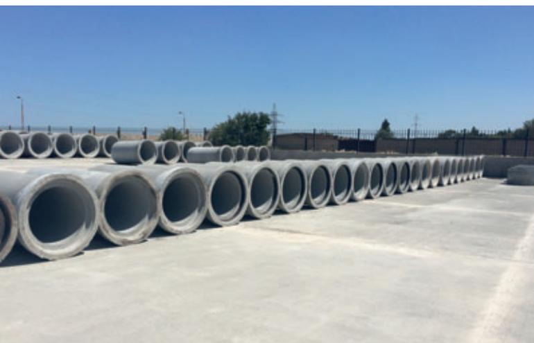
Fabrication de tuyaux en béton armé avant la livraison au client
