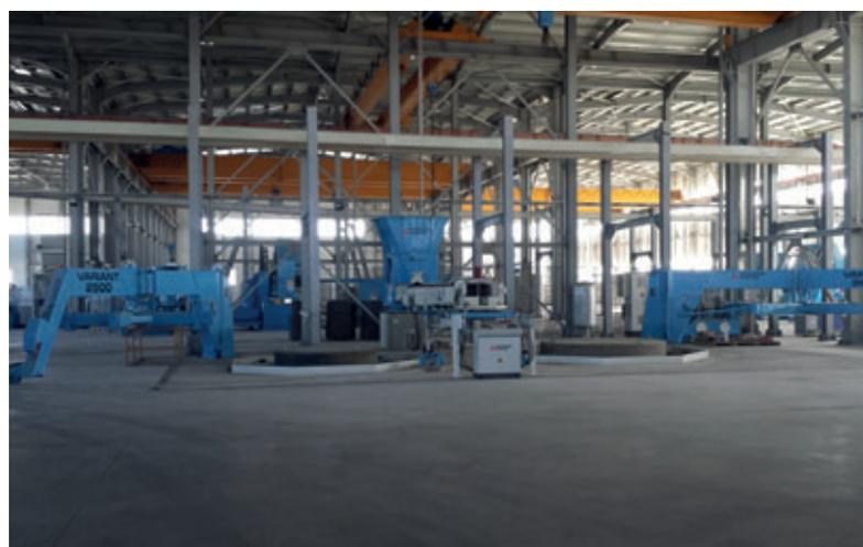
La Variant 3600/2500 de Prinzing-Pfeiffer pour les tuyaux en béton
