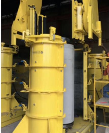
Démoulage d'un tuyau de fôçage durci
