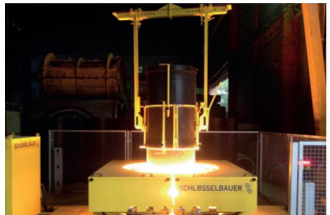
Mise en forme des extrémités du liner Perfect selon un procédé thermoplastique, pour la pose ultérieure du connecteur dans le tuyau
