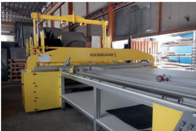
Découpe et soudure du liner Perfect selon le diamètre de tuyau désiré, en mode automatique
