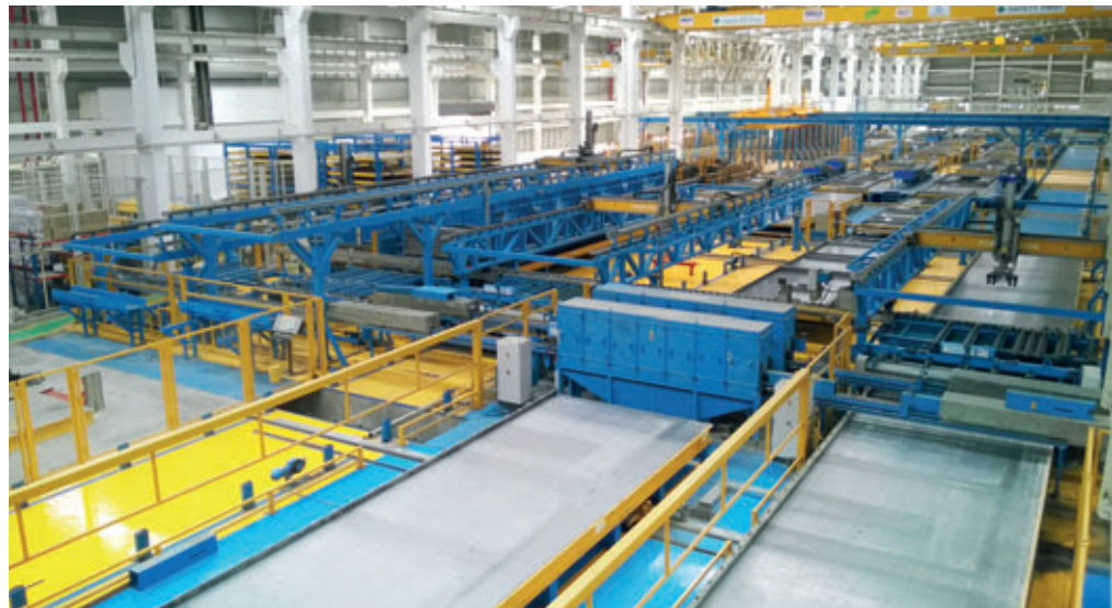
Vista de la nueva planta de alto rendimiento de Pruksa: el desencofrado y encofrado de las bandejas, así como la limpieza y la lubricación de las bandejas y los separadores están completamente automatizados.
