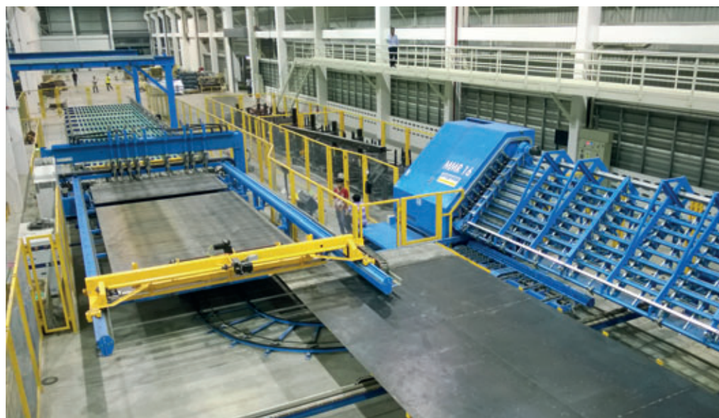
La instalación de soldadura de mallas M-System Evolution fabrica las mallas de armadura «en el momento preciso» y de forma exacta para la bandeja correspondiente.
