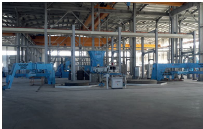
La máquina Variant 3600/2500 de Prinzing-Pfeiffer para tubos de hormigón hasta \text{Æ}3600 mm y una longitud máxima de 3,0 m
