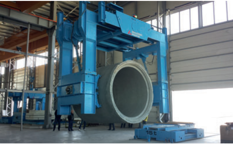
Pinza de giro de tubos para productos de hasta 15 t de peso
