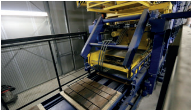
La máquina bloquera XL 9.1 de Masa en funcionamiento
