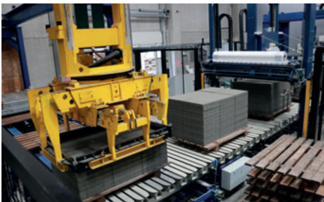
Cuboter de Masa: el empaquetado, controlado completamente por sistema servo, recoge las planchas de bloques de diferentes posiciones de recogida y las deposita formando un paquete sobre la vía de transporte
