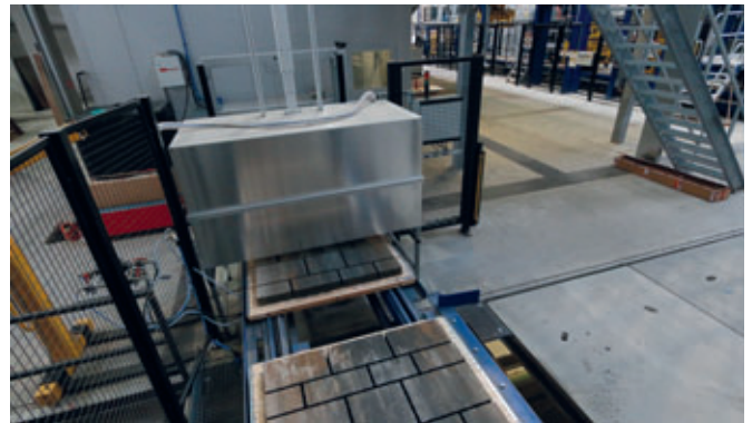
Por el lado húmedo, los productos frescos pasan por una instalación de rociado para aplicar, si se desea, un recubrimiento a la superficie
