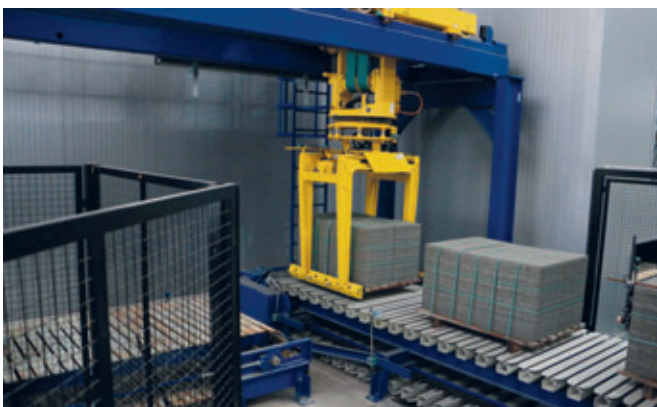
Otro desplazador de Masa recoge los paquetes de bloques flejados y los deposita en una vía de transporte de paquetes dispuesta en un ángulo de 90°
