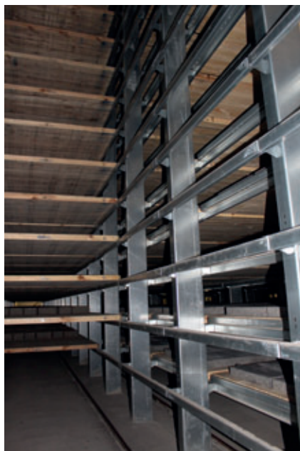
La capacidad total de la instalación de curado es de 7392 bandejas
