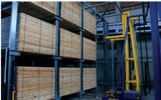
El carro de transporte de paquetes recoge los paquetes listos y los devuelve automáticamente a la máquina bloquera o los deposita en la pila de la estantería auxiliar
