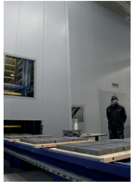
Las bandejas son separadas por el descensor y colocadas en el transportador de elevación libre del lado seco
