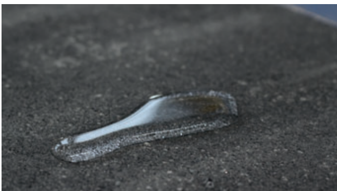
Los artículos de hormigón fabricados en la instalación de Masa tienen una estructura de la superficie muy densa
