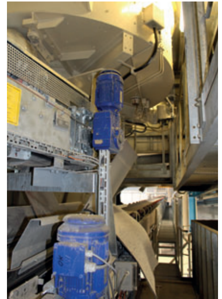
El mezclador RIH 0.5 de Liebherr se utiliza para la producción del hormigón bicapa; la descarga se realiza en una cinta transportadora
