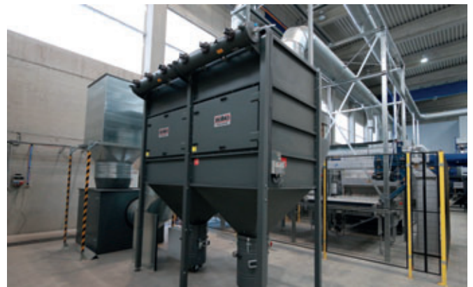
Sistema central de eliminación de polvo de Rotho
