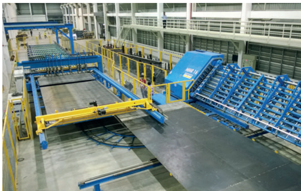
Die Mattenschweißanlage M-System Evolution fertigt die Bewehrungsmatten just-in-time und passgenau für die jeweilige Palette.
