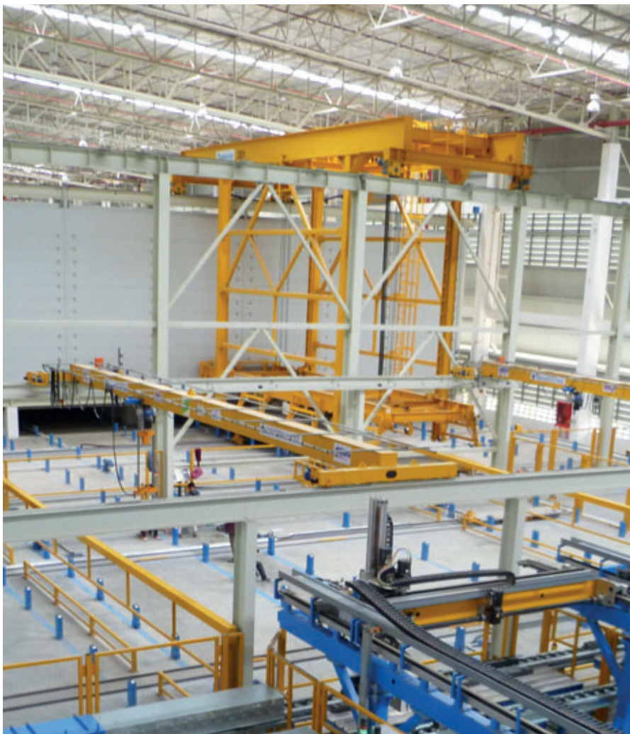
Das Ein- und Auslagern der Paletten erfolgt mit einem vollautomatischen Regalbediengerät. ebos® errechnet die notwendige Verweildauer im Härteregal und sendet diese Daten entsprechend an die Maschine.
