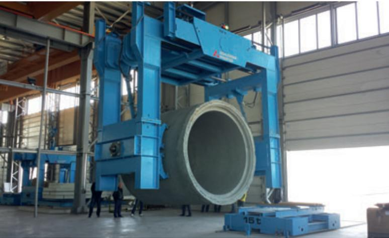
Rohrwendegreifer für Produkte bis 15 t Gewicht
